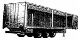
Plateau équipé de bâches coulissantes sur les côtés et le dessus du véhicule. Nom d'usage : **TAUTLINER**.
