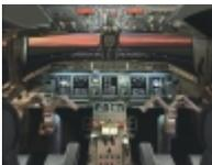
Les commandes de vol et l'avionique sont gérées à partir du cockpit dans lequel se trouve l'équipage au travers de panneaux d'instruments et d'actionneurs qui constituent l'interface homme machine.
