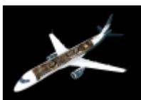
La cellule est constituée du fuselage, de la **voilure**, de **l'empennage** horizontal et vertical et du **train d'atterrissage**. On obtient alors un planeur. La forme de la cellule, en dehors des considérations aérodynamiques, est déterminée par la fonction de l'appareil : ce sont les emports.
