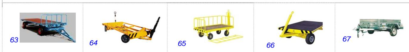
**LES REMORQUES :** ce sont des chariots sur deux ou quatre roues et munis d'un dispositif qui permet leur attelage à un véhicule tracteur
