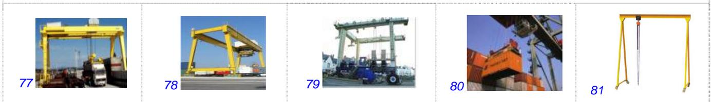
**LES PORTIQUES :** ce sont des supports verticaux reliés à leur sommet par des éléments horizontaux sur lesquels on agrippe des palans ou des treuils. Sur les quais on retrouve des portiques coulissants sur des rails, des portiques sur roues et des portiques fixes. Ils servent aux opérations de chargement déchargement
